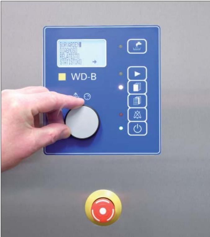
Die Steuerung der RHIMA WD-B Bandspülmaschinen ist mit einem Klarsichtfeld versehen, das die Betriebszustände, Meldungen und Servicewerte übersichtlich darstellt. Ein interner Speicher dokumentiert sämtliche Daten, die nach HACCP notwendig sind.
