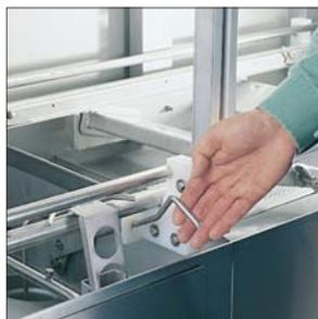
Alle Tanks können mit einem Hebel entleert werden. Alle unteren Abläufe und auch das Überlaufrohr werden automatisch geschlossen, wenn die Tür in der Spülzone geschlossen ist.
