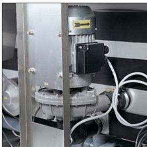
Selbstentleerende Pumpen verbessern die Hygiene bei der Maschinenreinigung.
