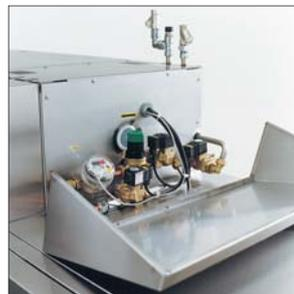
Das Druckventil, die Magnetventile und die Wasserstandsmesser für die Nachspülung befinden sich hinter einer Scharniertür.
