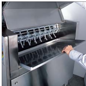
Einfahrtzone mit gesicherter Tür und einfach zu reinigenden Oberflächen- filtern.
