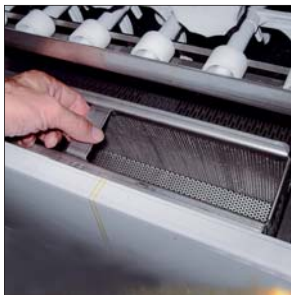
Oberhalb des Wasserstands in den Waschtanks sind einfach zu entfernende Schmutzsiebe aus Edelstahl montiert.
