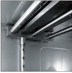
Außenliegende Steigrohre für eine bessere Hygiene in der Maschine. Waschsysteme mit seitlichen Waschrohren.
