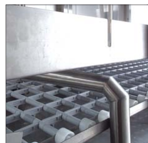
Turbo-Gebläse zum abblasen des Waschguts von seitlich und von unten.
