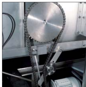
Die Maschine ist standardmäßig mit zwei Transportgeschwindigkeiten ausgerüstet und mit einer Rutschkupplung gesichert. Gegen Aufpreis kann ein Frequenzregler für das Förderband geliefert werden, mit dem die Bandgeschwindigkeit konform den Wünschen des Benutzers eingestellt werden kann.
