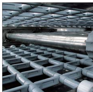
Die Wascharme haben einen Bajonetverschluss und können daher schnell und einfach herausgenommen werden. Die Düsenöffnungen sind selbstreinigend. Der Ober- und Unterdruck der Wascharme ist einstellbar.
