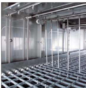
Nachspülunterbrecher mit Taster aus synthetischem Material. Beugt Schäden am empfindlichsten Porzellan vor.
