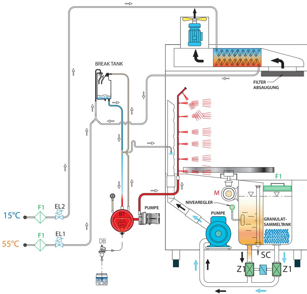
*Dank des Break-Tanks und der Drucksteigerungspumpe ist die Nachspülung vom Wasserdruck unabhängig.*
